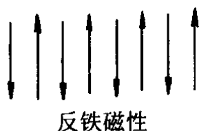
图 8-23 反铁磁性的磁矩排列
