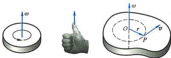
图 3-5 角速度矢量和线速度
