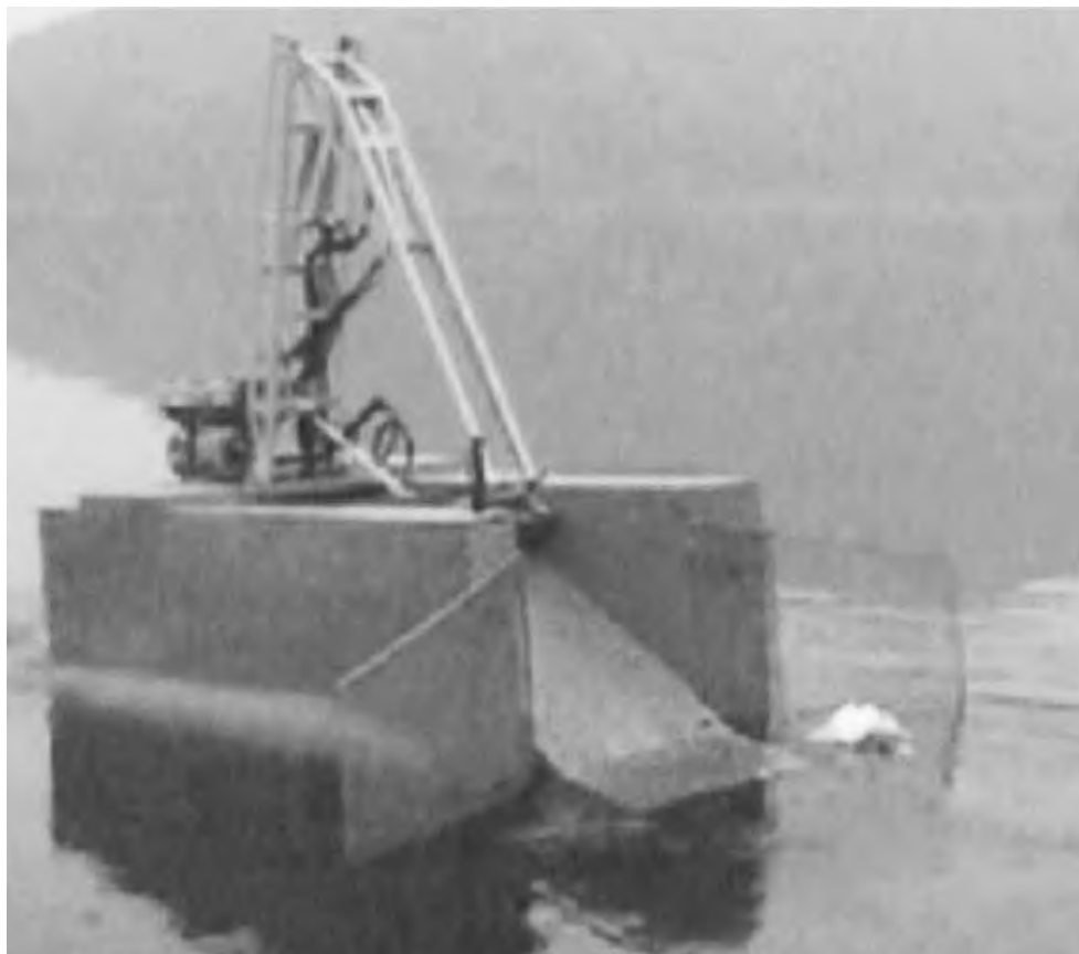
图6-26 水上清洁机器人在湖中打捞垃圾现场
