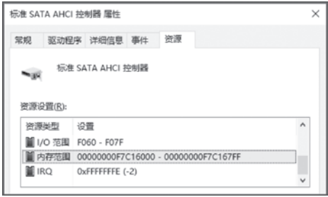
图 9.3 Windows 系统中的 I/O 编址
