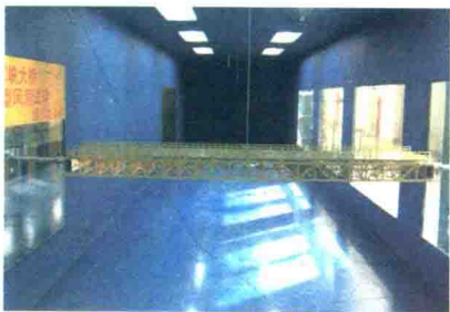
图 10.7 刘家峡大桥的风洞试验
