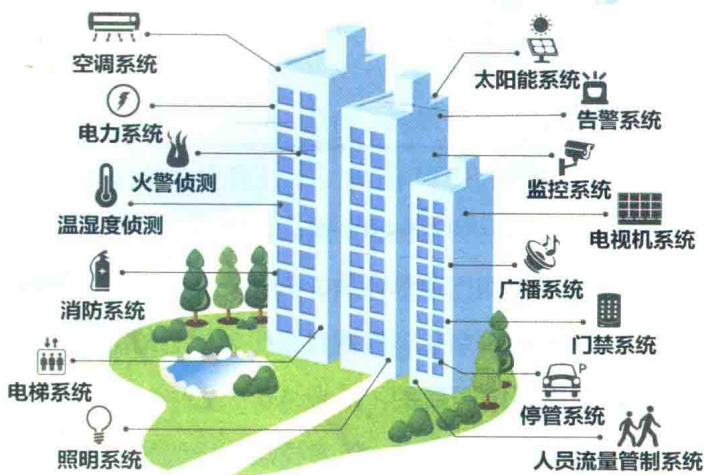
图12.4 智慧建筑的构成系统
