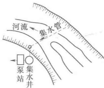
图 5.34 垂直于河流布置的渗渠
