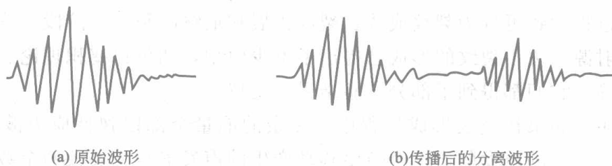
图 8-3 导波传播引起的波形分离现象
