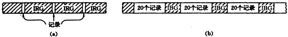
图 11.2 磁带上信息存放示意图 (a) 字符组长 80 字符的磁带；(b) 成块存放的磁带
