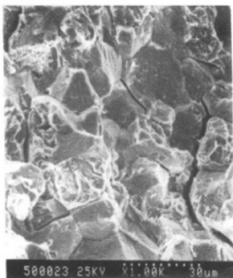
图 12-11 30CrMnSi 钢沿晶断二次电子像
