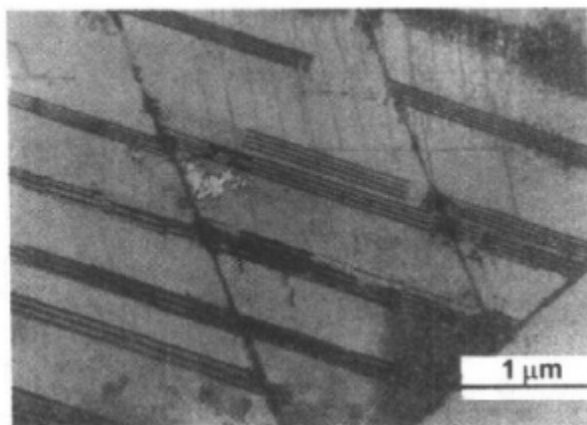
图 11-17 不锈钢中的层错形态
