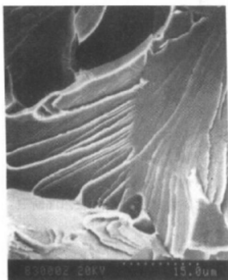
图 12-13 低碳钢冷脆解理断口的二次电子像
