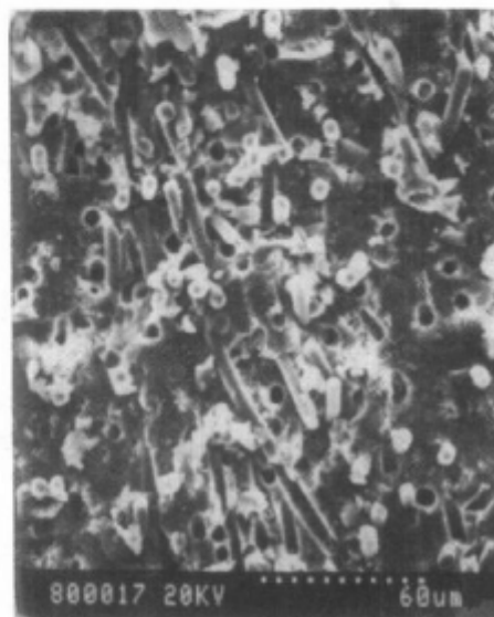
图 12-13 低碳钢冷脆解理断口的二次电子像
