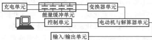
图 3-26 电动机操动机构各单元之间的连接
