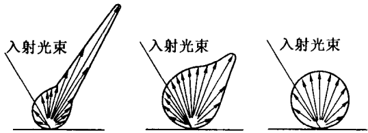
图 4.15 粗糙度增加的镜反射、漫反射能量图
