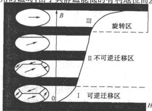
图 3.37 磁化曲线分区示意图
