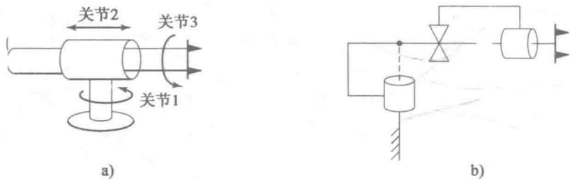
图 3-9 包含一个移动关节的三自由度操作臂
