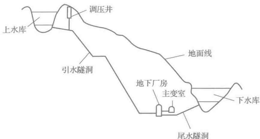
图 1-2 纯抽水蓄能电站示意图
