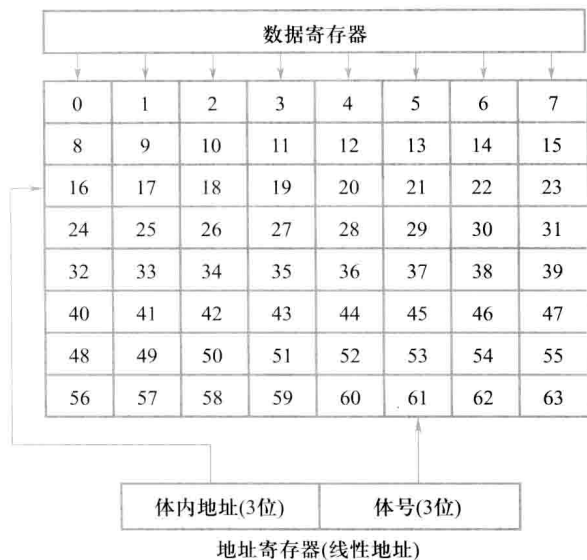
图 5.33 采用低位交叉编址的存储器(8 个存储体)
