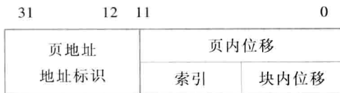
图 5.25 IBM 3033 的 Cache 中索引字段和页内位移的关系
