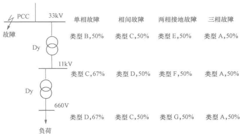
图 6-38 星形连接负荷的电压暂降变换
