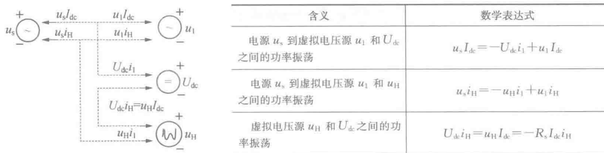
图 2-11 非线性电阻负载的非有功功率流
