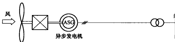
图 4-18 定桨距恒速恒频运行的并网异步风力发电机系统结构示意图
