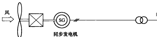
图 4-13 定桨距恒速恒频运行的并网同步风力发电机系统结构示意图
