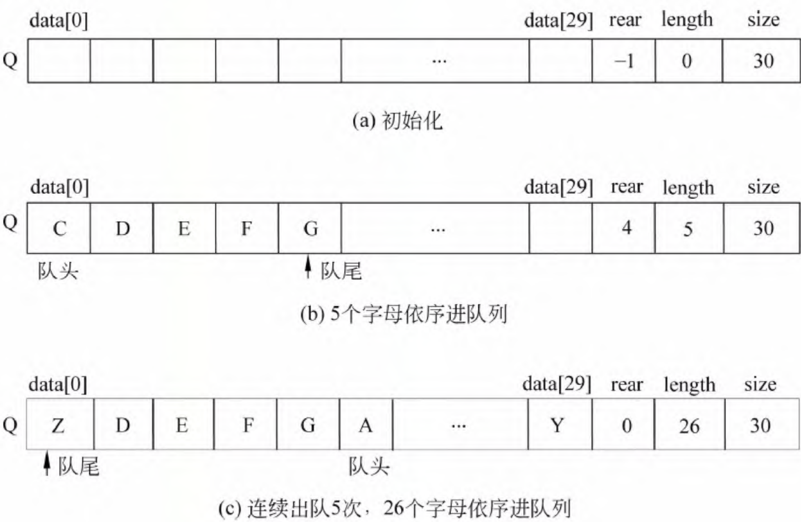
图 3-23 循环队列示意图
