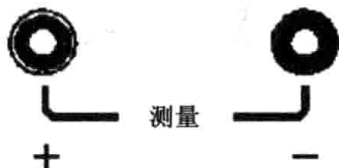
图 2-10-4 ZD-WC 精密数字式电子电位差计测量接线端口
