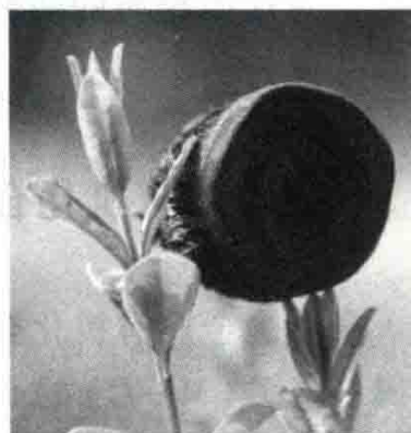
(b) 石墨烯气凝胶材料立于植物茎上
