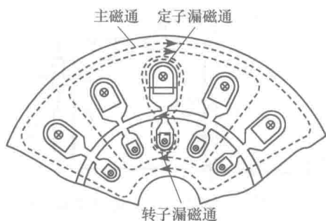
图 19-7 三相异步电动机定、转子漏磁通
