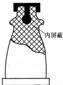
图 2-6-9 支柱绝缘子的内屏蔽电极示意图
