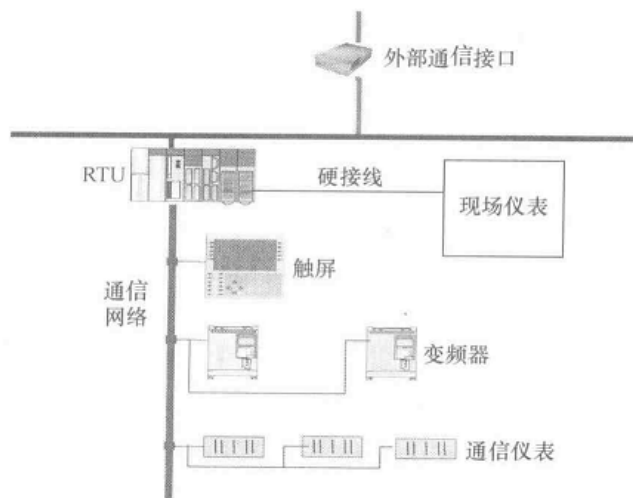
图 17-7 换热站通信系统连接示意图
