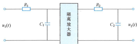
图 3-16 加入隔离放大器的阻容网络
