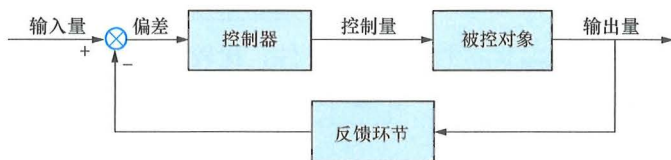
图 1-2 闭环控制系统
