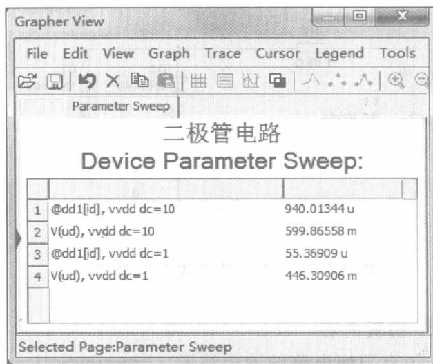
图 1.5.2 二极管两端的电压和电流
