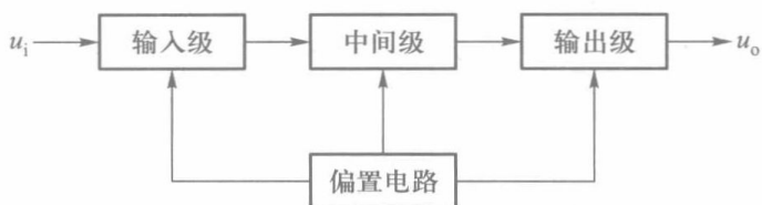
图 5.3.1 集成运算放大电路的原理框图
